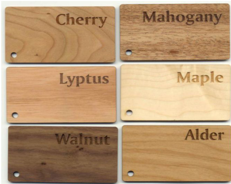
FIGURA 5 - Tipos de chapas de madeira para corte e gravação.
